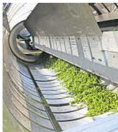
Im sich drehenden Zylinder werden die gerüsteten Bohnen sortiert.
